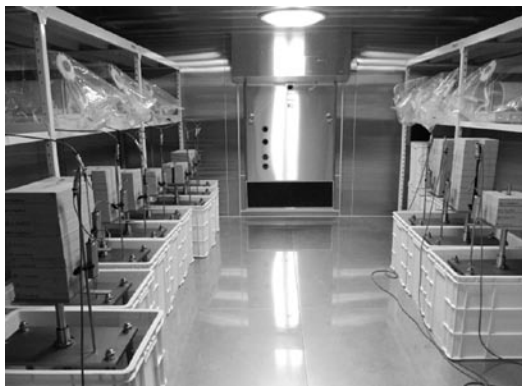
写真－5 長期曲げ特性試験 (恒温恒湿室)
