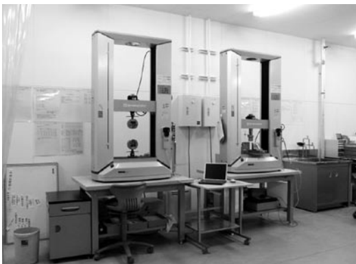
写真-2 材料特性試験(精密万能試験機)
