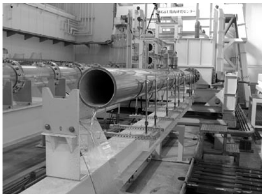
写真－6 粗度係数測定 (水理シミュレーション装置)
