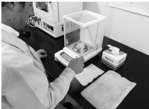
写真－4 耐薬品性試験状況
